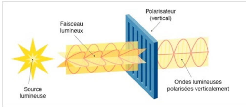
Ce polariseur possède 2 axes  $OX, OY$  et ne laisse passer que la composante de  $\mathbf{E} //$  à un de ces axes.
