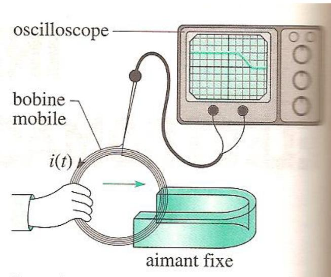
Un circuit se déplaçant dans un champ magnétique permanent peut se comporter comme un générateur électrocinétique. On observe un courant  $i$ . Il est le siège d'un phénomène d'induction. C'est **l'induction de Lorentz**.
