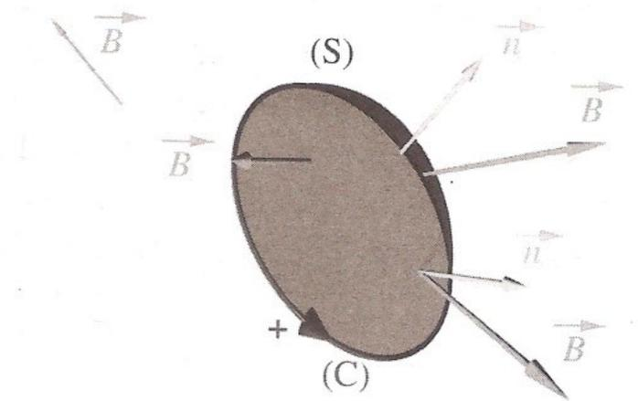
Où  $\Phi = \iint \vec{B} \cdot d\vec{S}$  est le flux du champ magnétique à travers une surface s'appuyant sur le circuit fermé.
