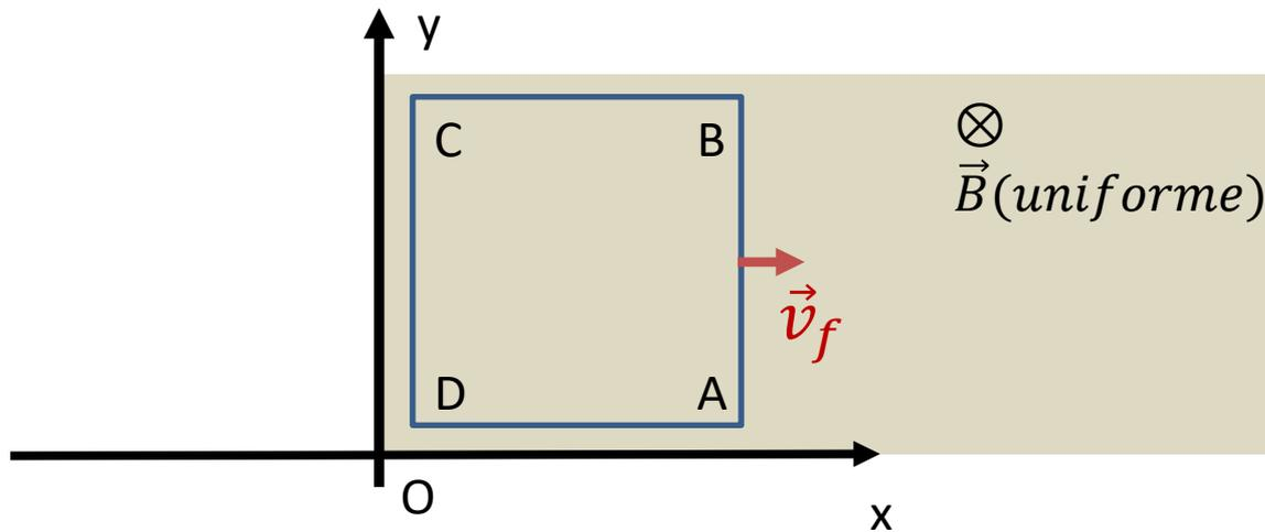
Pour  $x > a$ ,  $\vec{B} \neq \vec{0} \Rightarrow \vec{E}_m = \vec{v}(t) \wedge \vec{B}$
