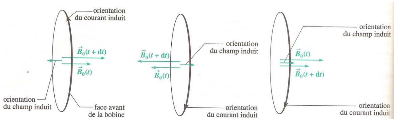
Loi de Lenz : L'induction est à l'origine d'un courant induit  $i$  :
