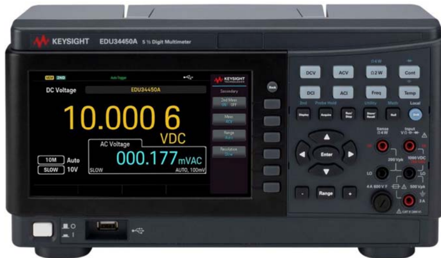
Figure 1 : face avant du multimètre Keysight EDU34450A
