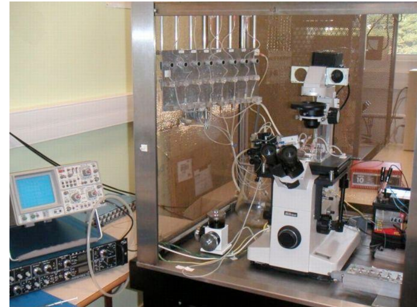
Cuvette, micromanipulateur et Microscope sur table anti-vibration sur coussin d'air et cage de faraday
