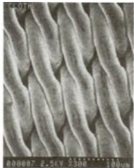
(a) filtre en acier inoxydable : \varepsilon = 0,358 , \alpha = 6,67 \times 10^4 \text{ m}^{-1} , structure ordonnée, diamètre des pores = 10 \mu\text{m} ([8])
