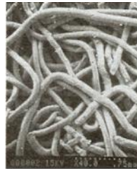
(b) mèche poreuse en fibre d'acier inoxydable, structure désordonnée ([8])
