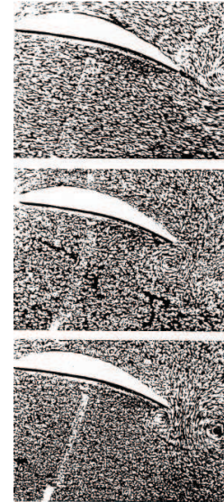
FIGURE 12.7 – Apparition de la portance par émission de vortex : (a) démarrage de l'aile et émission d'un tourbillon positif au niveau du bord de chute créant une circulation négative sur l'aile, (b) arrêt de l'aile qui relâche un tourbillon négatif, (c) deux tourbillons de sens contraires sont formés par le démarrage et l'arrêt de l'aile.
