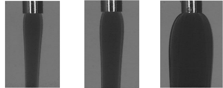
FIGURE 7.8 – Ecoulement d'un fluide visco-élastique montrant le gonflement progressif d'un jet à la sortie d'un tube lorsque le taux de cisaillement augmente ( \dot{\gamma} = 24 puis 60 puis 240 \text{ s}^{-1} ), ce qui démontre l'existence de contraintes normales dans ce fluide. (Photos L. Pauchard, FAST Orsay.)
