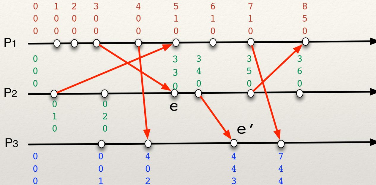
$$L(e) = \begin{pmatrix} 3 \\ 3 \\ 0 \end{pmatrix} \text{ et } L(e') = \begin{pmatrix} 4 \\ 4 \\ 3 \end{pmatrix} \text{ comme } \begin{matrix} 3 < 4 \\ 3 < 4 \\ 0 < 3 \end{matrix} \Rightarrow V(e) <_v V(e')$$
