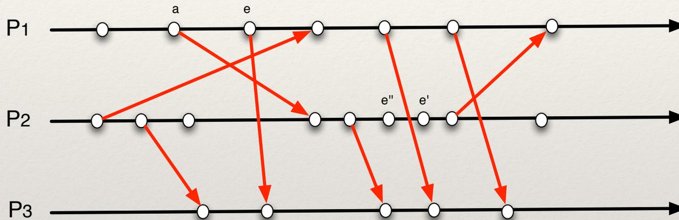
Comme  $a \rightarrow e'$  on a  $v(a) = \begin{pmatrix} a_i \\ a_j \\ a_k \end{pmatrix}$  et  $v(e') = \begin{pmatrix} a_i \\ e'_j > a_j \\ \max\{e''_k, a_k\} \end{pmatrix}$  on a  $\Rightarrow V(a) <_v V(e')$
