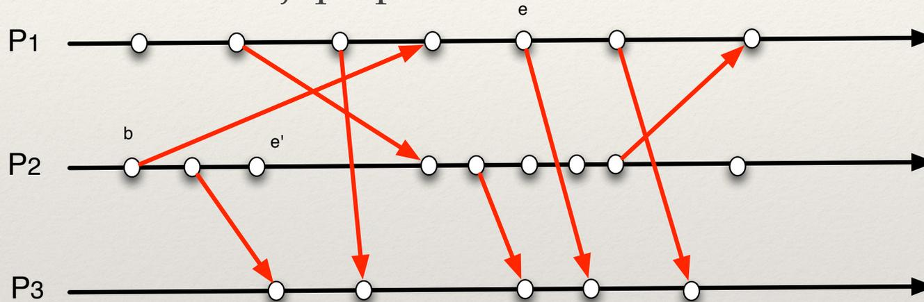
$$\text{Comme } b \rightarrow e' \text{ on a } v(b) = \begin{pmatrix} b_i \\ b_j \\ b_k \end{pmatrix} \text{ et } v(e') = \begin{pmatrix} b_i \\ b_j + k \\ b_k \end{pmatrix} \Rightarrow V(b) <_v V(e')$$
