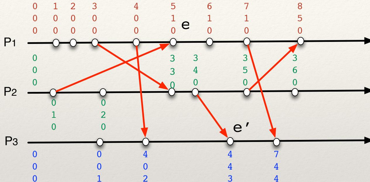
$$L(e) = \begin{pmatrix} 5 \\ 1 \\ 0 \end{pmatrix} \text{ et } L(e') = \begin{pmatrix} 4 \\ 4 \\ 3 \end{pmatrix} \text{ comme } \begin{matrix} 5 > 4 \\ 1 < 4 \\ 0 < 3 \end{matrix} \Rightarrow V(e) \text{ et } V(e') \text{ sont incomparables}$$
