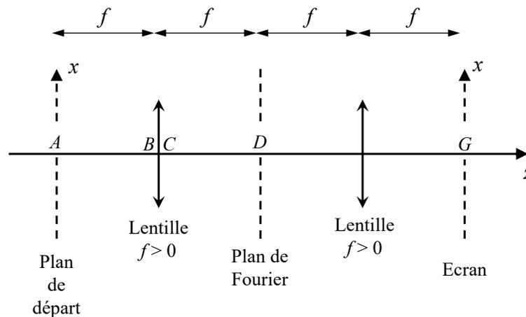
FIGURE 1 – Système de filtrage spatial  $4f$ .
