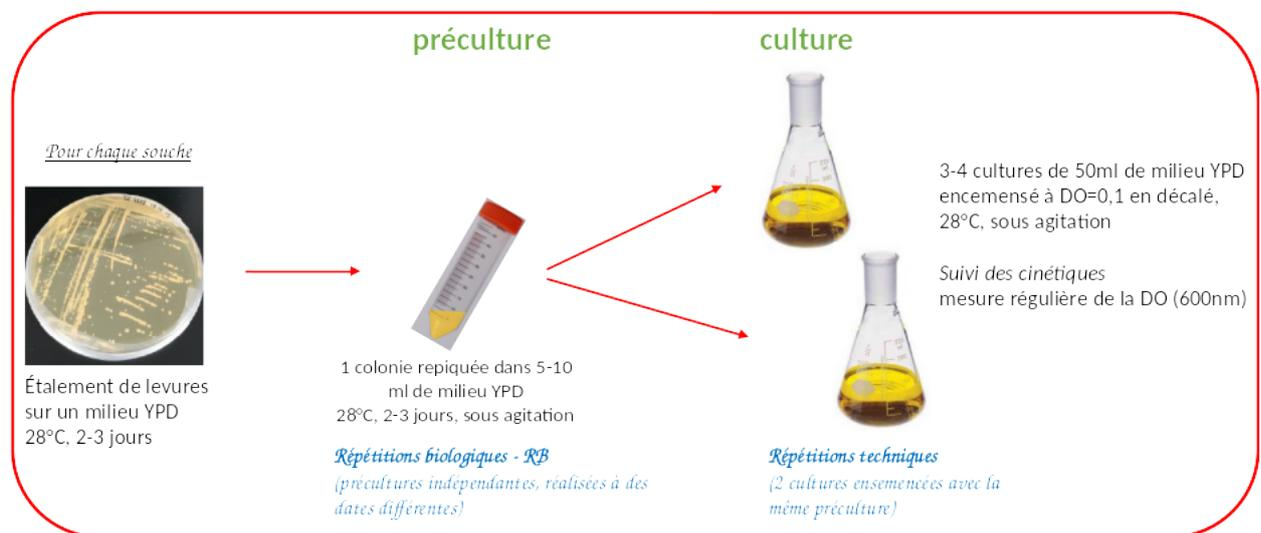
Figure 2: Mise en place de l'expérience pour une souche. Description fournie par N. Conde e Silva.
