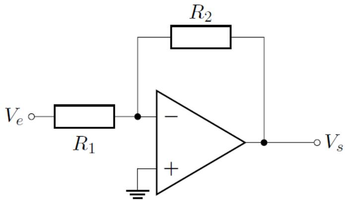
Figure 2.2 – Le montage amplificateur inverseur
