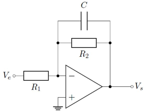
Figure 2.6 – Montage d'un filtre passe-bas du 1<sup>e</sup> ordre.
