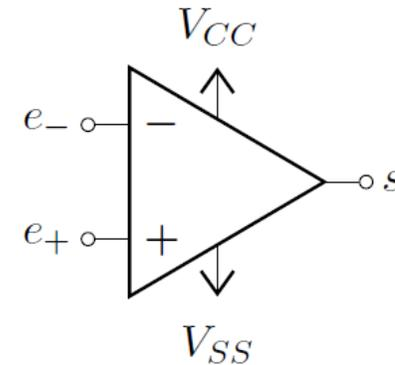
Figure 1.3: brochage d'un Amplificateur Opérationnel.
