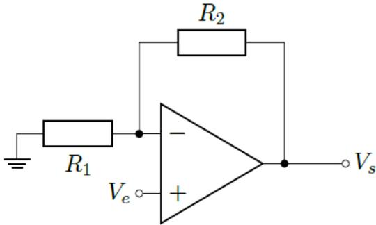
Figure 1.8 – exemple de montage en régime linéaire (non-inverseur)
