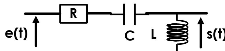
Calculez la fonction de transfert et les diagrammes de Bode du circuit précédent lorsque l'on est aux bornes des autres composants (la résistance ou de la bobine).
