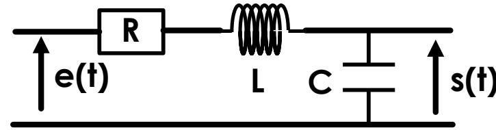
1. Sans calcul, donnez l'allure de ce filtre aux basses ( $\omega - > 0$ ) et hautes fréquences ( $\omega - > \infty$ ).
