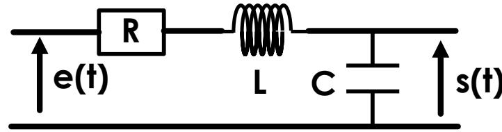
1. Sans calcul, donnez l'allure de ce filtre aux basses ( $\omega \rightarrow 0$ ) et hautes fréquences ( $\omega \rightarrow \infty$ ).
