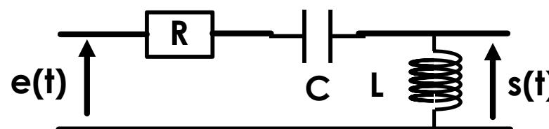
Calculez la fonction de transfert et les diagrammes de Bode du circuit précédent lorsque l'on est aux bornes des autres composants (la résistance ou de la bobine).
