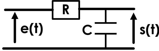
1. Sans calcul, donnez l'allure de ce filtre aux basses ( $\omega - > 0$ ) et hautes fréquences ( $\omega - > \infty$ ).
