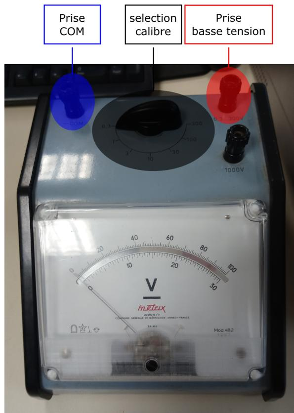
FIGURE C.1 – Photo du voltmètre analogique.
