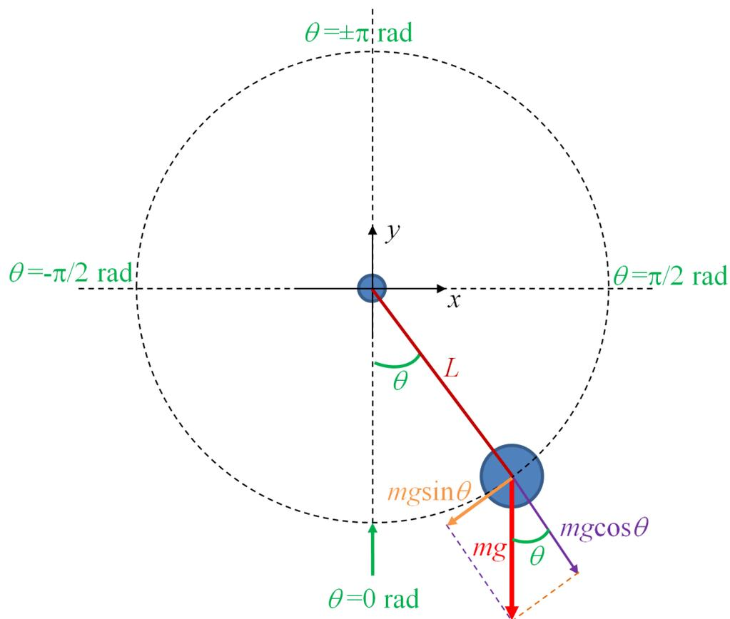
FIGURE 22.3 – Caractérisation géométrique d'un pendule simple.
