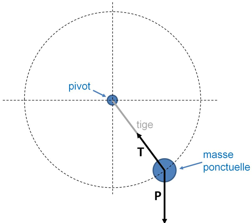
FIGURE 22.2 – Bilan des forces dans un pendule simple.
