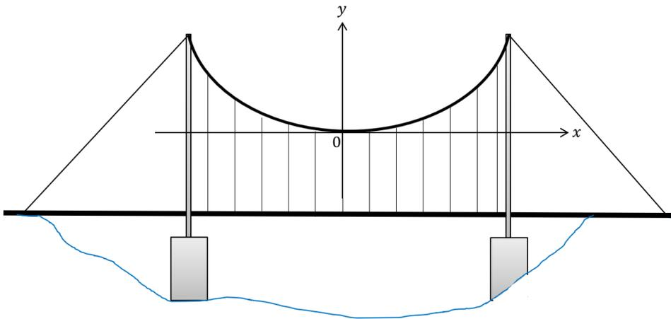
On définit un système élémentaire composé d'une portion de tablier, entre les abscisses  $x$  et  $x+dx$  et l'élément de câble qui le soutient. La figure suivante montre les forces qui s'appliquent à cet ensemble : le poids du tablier et les tensions de part et d'autre de l'élément de câble. On note  $\vec{T}(x)$  la tension exercée à l'abscisse  $x$  dans le câble.
