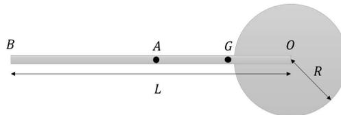
On note  $O$  le centre du disque et  $A$  le centre de masse de la tige (situé au milieu de la tige). On suppose que la tige et le disque ont la même masse  $M$ .
