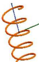
FIGURE 1.1 – Trajectoire en hélice d'une particule chargée positivement dans un champ magnétique uniforme. La flèche bleue indique la direction du champ magnétique tandis que la flèche verte indique la direction de la vitesse à un temps donné.
