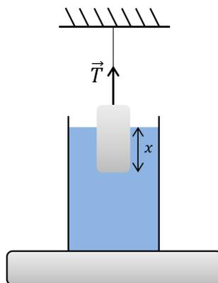
FIGURE 1 – Cylindre plongé progressivement dans l'eau.
