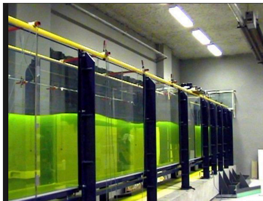
canal à houle
