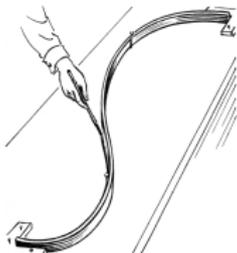
Une baguette de bois souple (en anglais "spline") est contrainte en position et en angle à chaque extrémité (pour obtenir la continuité et la continuité des dérivées première et seconde), et en position en un ou plusieurs points intermédiaires.
