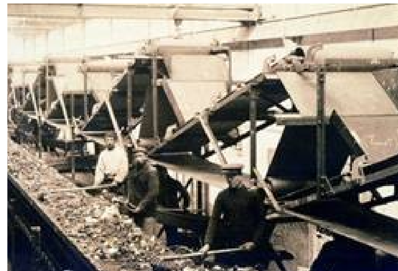
Des ouvriers attirent les ordures dans la trémie placée au dessus de chaque broyeur.
