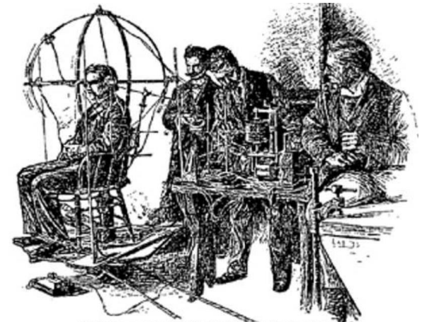
Chaise tournante pour l'étude de la localisation des sons au Laboratoire de psychologie expérimentale de l'Université Harvard.
