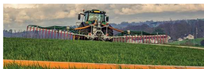
Épandeur sans tonne, SlurryKat Ltd (Site projet Ferti-Dig)
