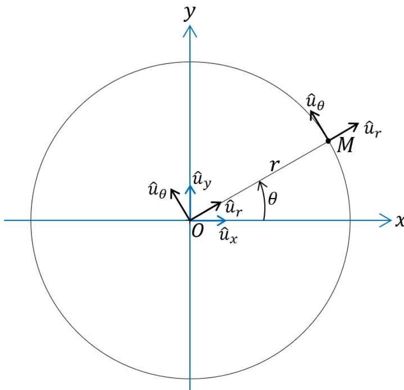
FIGURE 5.1 – Notations utilisées dans l'étude du mouvement circulaire uniforme en repère polaire.
