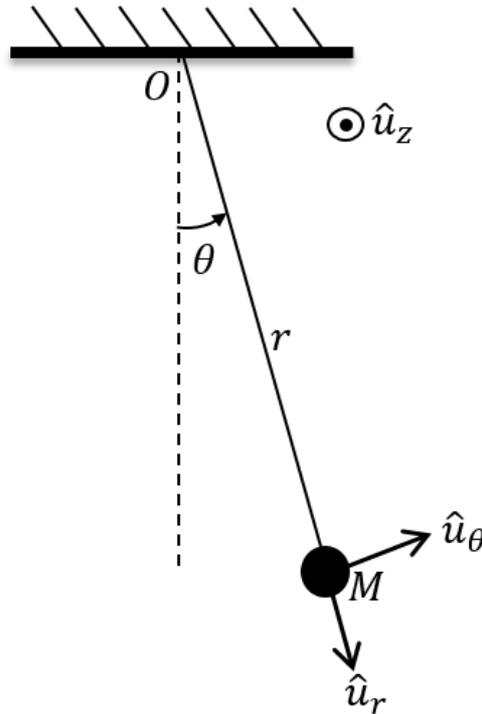
FIGURE 5.3 – Oscillation d'un pendule simple.
