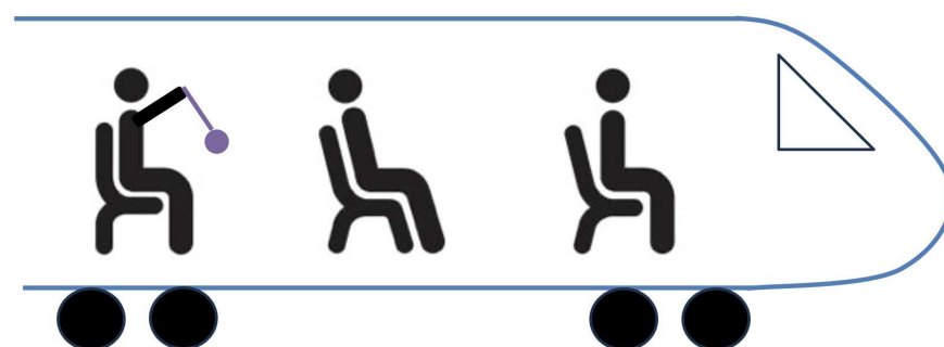
FIGURE 2.3 – Le train freine : tout se passe comme-ci la masse était soumise à une force supplémentaire.
