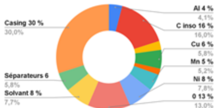
Composition moyenne d'une batterie lithium Véhicule électrique
