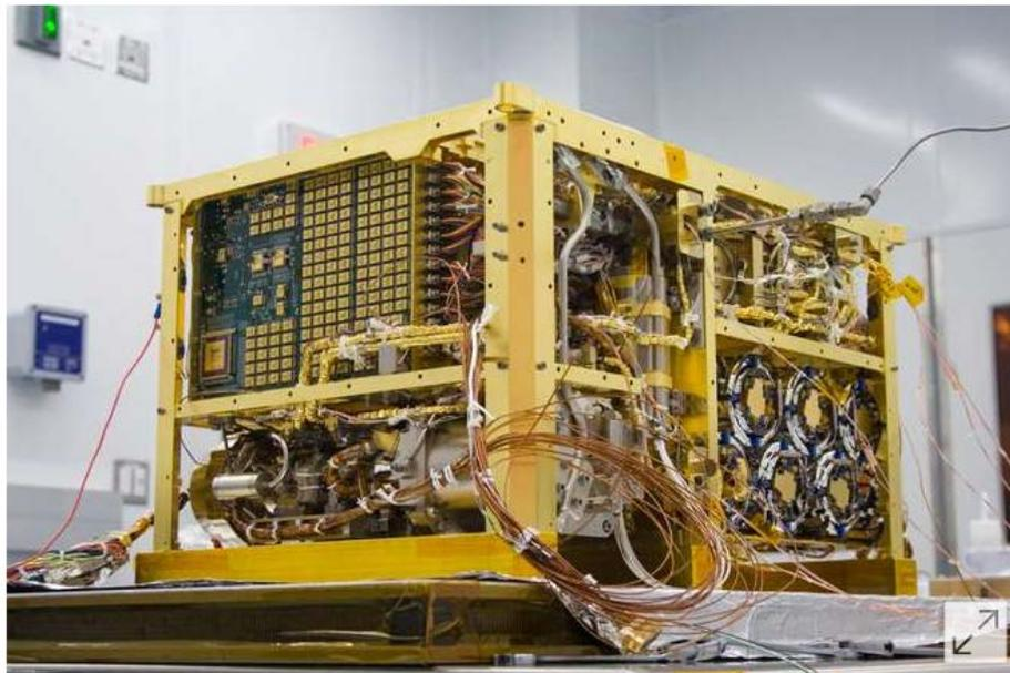
**L'instrument SAM, inséré dans le « ventre » de Curiosity, permettant de mener diverses expériences sur les échantillons prélevés. © Nasa, JPL-Caltech**
