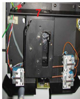
photos 2 : Spectrophotomètre correspondant à la photo 1 ouvert afin de distinguer les principaux constituants
