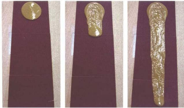
Figure 26 – Avalanche d'une suspension d'argile sur un plan incliné (l'inclinaison reste fixe). La structure est progressivement détruite au cours de l'écoulement (thixotropie) : le rajeunissement du liquide l'emporte sur le vieillissement, facilitant la destruction de la structure et engendrant une avalanche. Le fluide ne s'écoule qu'au-delà d'une certaine inclinaison : il s'agit donc également d'un fluide à seuil.
