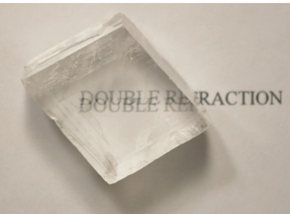
Double réfraction à travers un cristal de calcite
