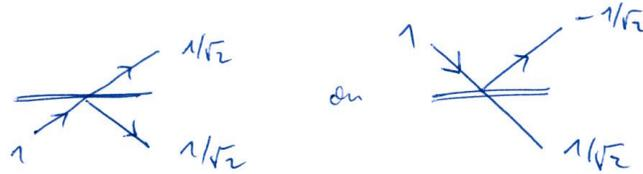
FIGURE 8.13 – Effet des lames semi-réfléchissantes sur l'amplitude de la fonction d'onde.
