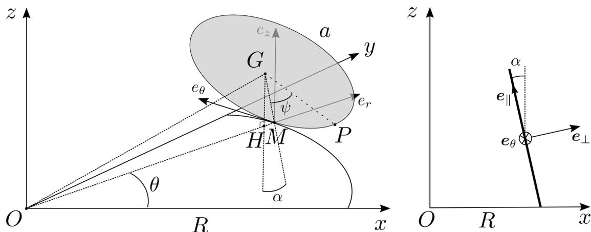
FIGURE 1 – (Gauche) Disque (grisé) de rayon  $a$  en roulement sans glissement sur un cercle de rayon  $R$ . L'angle  $(HGM) = \alpha$  correspond à l'inclinaison de la pièce par rapport à la verticale. (Droite) Disque vu de côté (configuration à  $\theta = 0$ ) muni des axes principaux d'inertie  $(\mathbf{e}_\perp, \mathbf{e}_\theta, \mathbf{e}_\parallel)$ .
