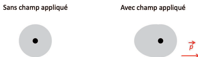
FIGURE 2.14 – Déformation du nuage électronique d'un atome isolé sous l'influence d'un champ \vec{E} .
