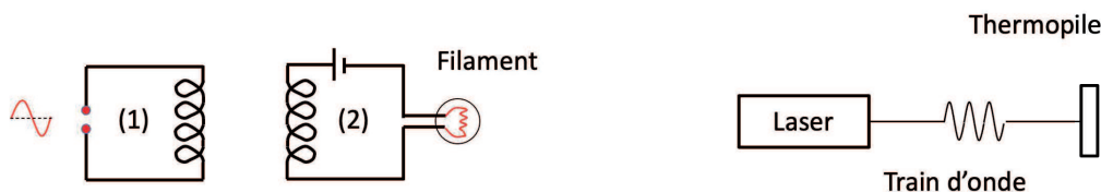
FIGURE 1.3 – Ces deux expériences mettent en évidence la propagation de l'énergie dans le vide, en l'absence de support matériel.
