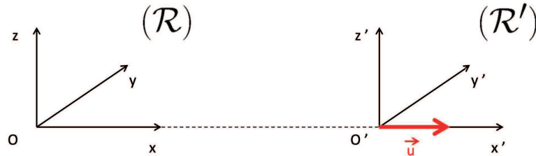
FIGURE D.1 – Déplacement de deux référentiels galiléens l'un par rapport à l'autre à la vitesse d'entraînement constante \vec{u} .
