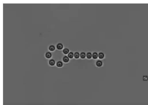
Images de particules piégées par laser et déplacées : pince optiques. Elliot Scientific Ltd.
