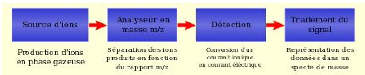
Figure 2: Structure d'un spectromètre de masse.
