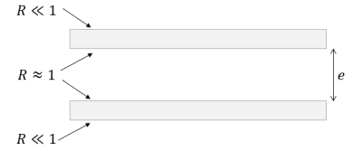
FIGURE 9.9: Schéma de principe d'un Fabry-Perrot. Les faces en regard doivent être plates avec un très haut degré de précision, parfaitement parallèles et séparées d'une distance e qui ne varie pas au cours du temps.
