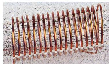
FIGURE 5.2: Principe d'un solénoïde et visualisation des lignes de champ magnétique à l'aide de limailles de fer.
