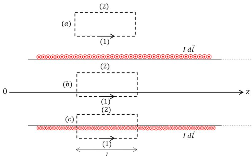
FIGURE 5.4 – Coupe d'un solénoïde. Les contours (a), (b) et (c) sont les contours cités dans le texte.
