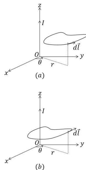
FIGURE 5.1: Circulation du champ magnétique produit par un fil infini le long d'un contour.
