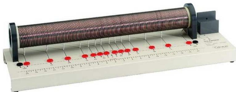
FIGURE 5.3 – Solénoïde utilisé en TP pour valider le résultat théorique. Le support à droite sert à positionner un capteur à effet Hall pour mesurer l'intensité du champ magnétique suivant un axe. Les différentes prises permettent de faire varier le nombre de spires de courant.
