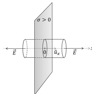
FIGURE 3.1: Champ électrique produit par une plaque infinie uniformément chargée.
