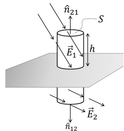
FIGURE 3.3: Démonstration de la discontinuité de la composante normale du champ électrostatique.
