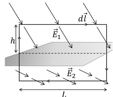
FIGURE 3.4: Démonstration de la continuité de la composante tangentielle du champ électrostatique.
