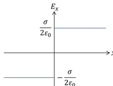
FIGURE 3.2: Graphe du champ électrique produit par une plaque infinie uniformément chargée.
