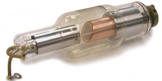
Typiquement, les rayons X sont produits dans un **tube de Coolidge**. Dans ce tube, un faisceau d'électron provenant de la cathode (filament en tungstène chauffé) percute l'anode, qui émet alors des rayons X provenant des interactions entre électrons incidents et atomes cibles
