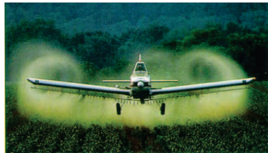
FIG. 1.4 – Tourbillons de bout d'aile visualisés lors de la pulvérisation d'insecticide.
