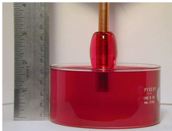
FIG. 6.9 – Illustration de « l'effet Weissenberg » lorsqu'un fluide élastique monte le long d'un cylindre en rotation ( http://web.mit.edu/nnf/ ).
