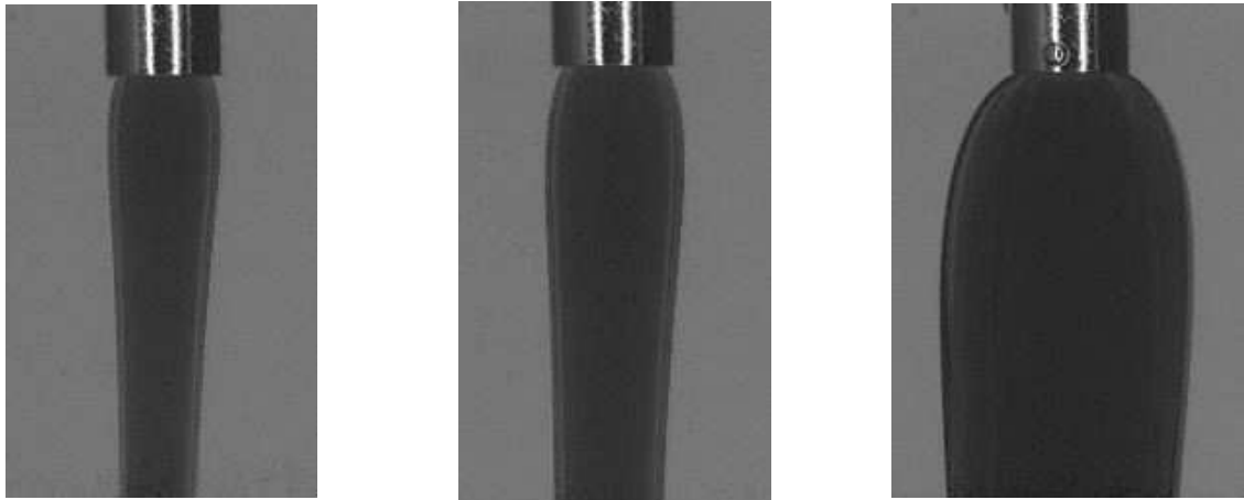
FIG. 6.8 – Ecoulement d'un fluide visco-élastique montrant le gonflement progressif d'un jet à la sortie d'un tube lorsque le taux de cisaillement augmente ( \dot{\gamma} = 24 puis 60 puis 240 \text{ s}^{-1} ), ce qui démontre l'existence de contraintes normales dans ce fluide. (Photos L. Pauchard, FAST Orsay.)
