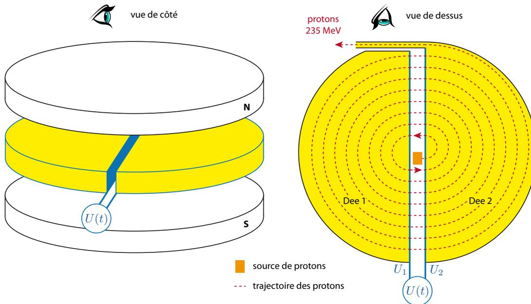
Il se compose de deux demi-cylindres horizontaux de rayon  $R$  très légèrement écartés et creux, les « Dees », au sein desquels règne un champ magnétique  $\vec{B}$  uniforme et constant d'intensité  $B = 1,67$  T. A l'intérieur des Dees, il règne un vide poussé. Entre ces deux Dees une tension haute fréquence en créneau de valeur maximale  $U = \pm 100$  kV crée un champ  $\vec{E}$  uniforme et constant, perpendiculaire aux faces en regard des Dees.
