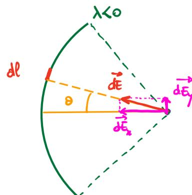
$$= \int_{\text{arc}} dE_x \cdot \vec{u}_x + \int_{\text{arc}} dE_y \cdot \vec{u}_y \quad \Delta dE_x \text{ et } dE_y \text{ sont du signe de } \lambda$$
