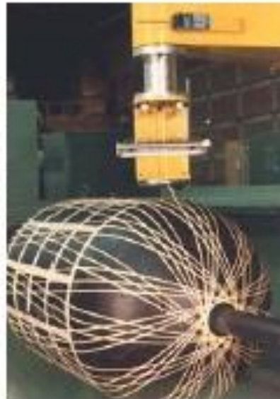
(b) enroulement hélicoïdal
