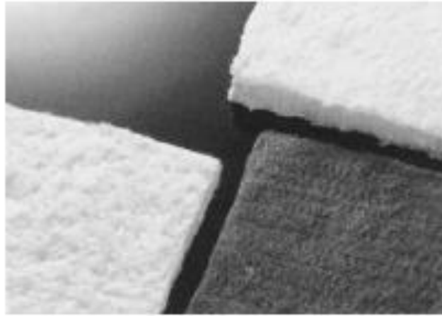
(b) fibres synthétiques et naturelles liées par aiguilletage
