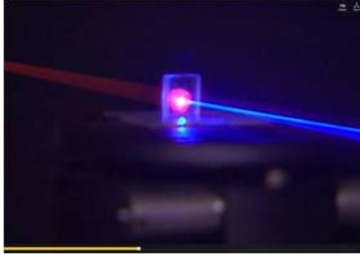
FIGURE 31 – Doublage de fréquence à l'aide d'un cristal non linéaire. Le laser incident de longueur d'onde 800 nm passe à travers le cristal et la lumière transmise est à la longueur d'onde 400 nm.
