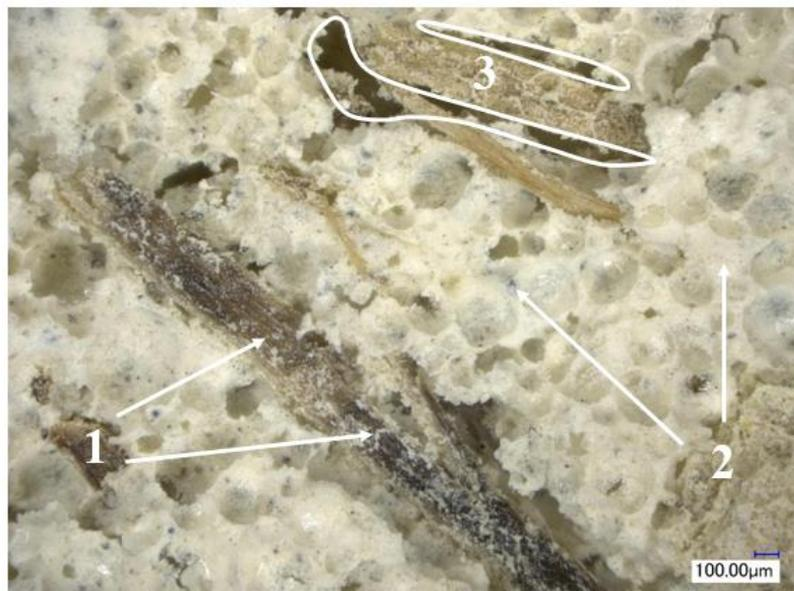
Figure 5 : Observation du béton de chanvre obtenue par microscope Keyence
