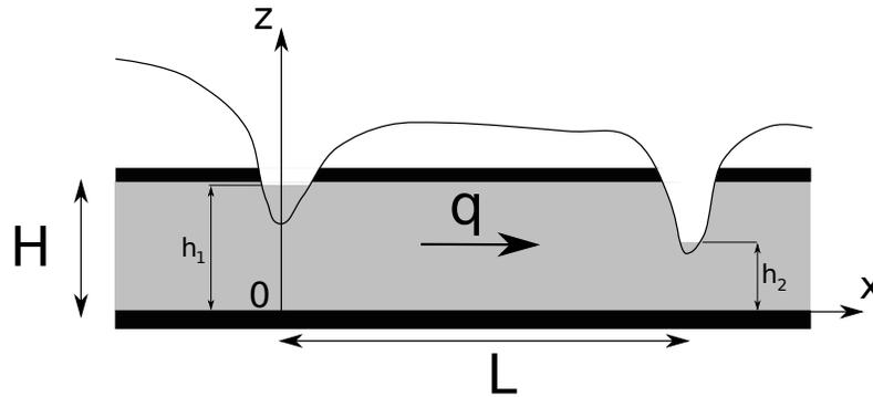
On considère un aquifère saturé en eau de perméabilité  $k$  et de porosité  $\Phi$  confiné par deux strates imperméables horizontales séparées de  $H$ . L'aquifère est en contact avec deux rivières distantes de  $L$  et dont le niveau d'eau sont  $h_1$  et  $h_2$ .
