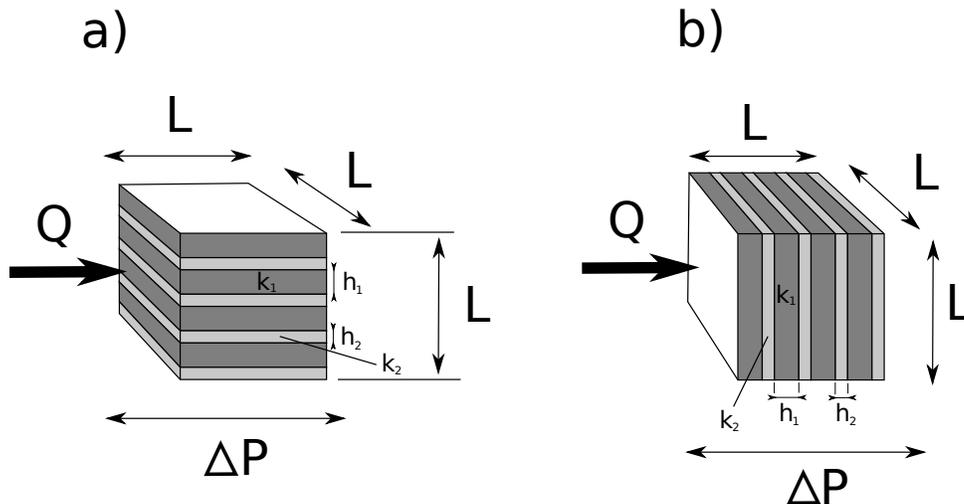
Dans cet exercice, on s'intéresse aux milieux poreux composites comprenant des parties de perméabilité  $k_1$  et des parties de perméabilité  $k_2$ . On suppose tous les pores du milieu saturés complètement d'un même fluide de viscosité  $\mu$ . On cherche dans cet exercice à évaluer leurs propriétés macroscopiques, c'est-à-dire définies par des mesures à une échelle de longueur grande devant la taille caractéristique des structures locales.
