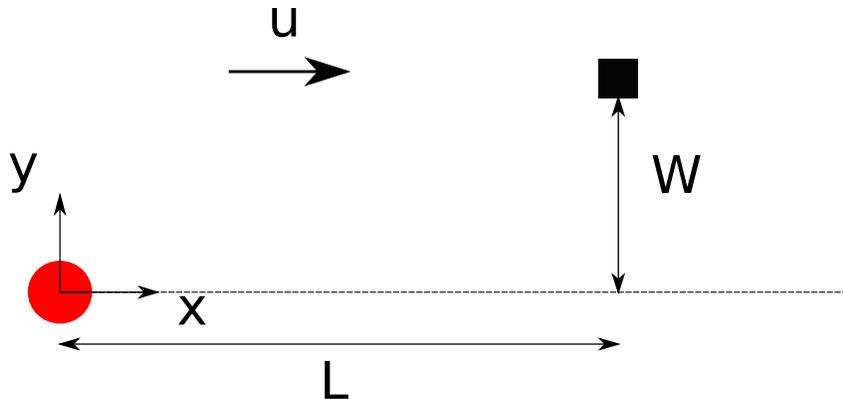
A un temps  $t = 0$ , une entreprise rejette des déchets industriels dans un puit abandonné qui se trouvent dans l'aquifère. L'aquifère a une perméabilité  $k = 10$  mDarcy, une porosité  $\phi = 0.2$ , et une dispersivité transverse  $\alpha_T = 5$  mm. La vitesse d'écoulement est de  $u = 1$  mm.jour<sup>-1</sup>. Une zone habitée se trouve à la position  $(L, W) = (2$  km, 5 m) par rapport au puit. On néglige la diffusion moléculaire.
