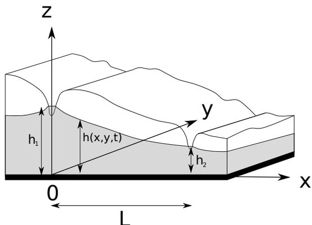
On considère un aquifère non confiné de perméabilité  $k$  et de porosité  $\phi$  au dessus d'un couche imperméable. Le milieu est supposé saturé en eau jusqu'à une hauteur d'eau  $h(x, y)$  (nappe phréatique).
