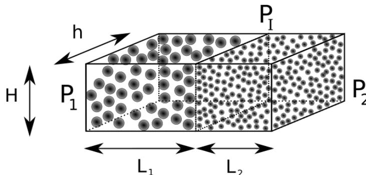
On juxtapose deux blocs de milieu granulaire constitués de grains de diamètres différents  $d_1 = 2 \text{ mm}$  et  $d_2 = 1 \text{ mm}$ . Les blocs ont la même hauteur  $H = 2 \text{ cm}$  et la même profondeur  $h = 2 \text{ cm}$ , les longueurs sont  $L_1 = 5 \text{ cm}$  et  $L_2 = 3 \text{ cm}$ . Les porosités sont  $\phi_1 = 0,3$  et  $\phi_2 = 0,2$ .
