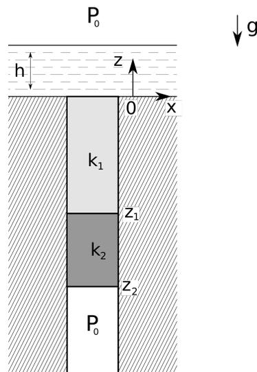
On considère un lac de profondeur  $h$  situé sur une roche imperméable. La roche présente une fracture verticale qui a été bouchée par deux types de sables. Ceux-ci forment ainsi deux couches de perméabilité différentes,  $k_1$  et  $k_2$ . En dessous de ces couches, l'eau s'évacue très rapidement. On supposera que la fracture est vide en dessous de  $z_2$  avec une pression égale à la pression atmosphérique  $P_0$ .
