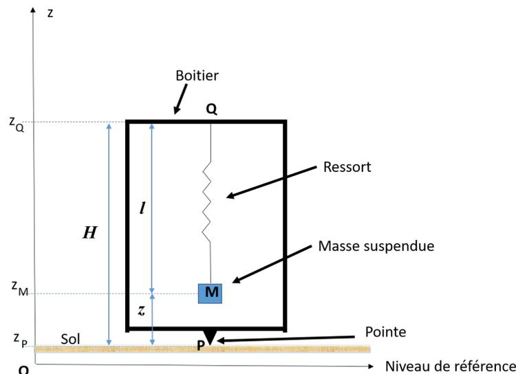
Figure 1: Schéma du sismomètre.
