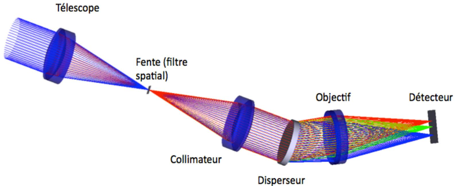
$$\infty \xrightarrow{\text{télescope}} \text{foyer} = \text{fente} \xrightarrow{\text{collimateur}} \infty \xrightarrow{\text{réseau}} \infty(\lambda) \xrightarrow{\text{objectif}} \text{foyer}(\lambda)$$
