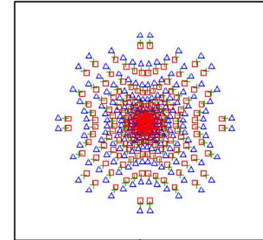
Le **spot diagram** correspond dans un plan donné aux points d'impact des rayons partants d'un point objet ayant traversés le S.O. Il permet de quantifier l'étalement géométrique due aux aberrations.
