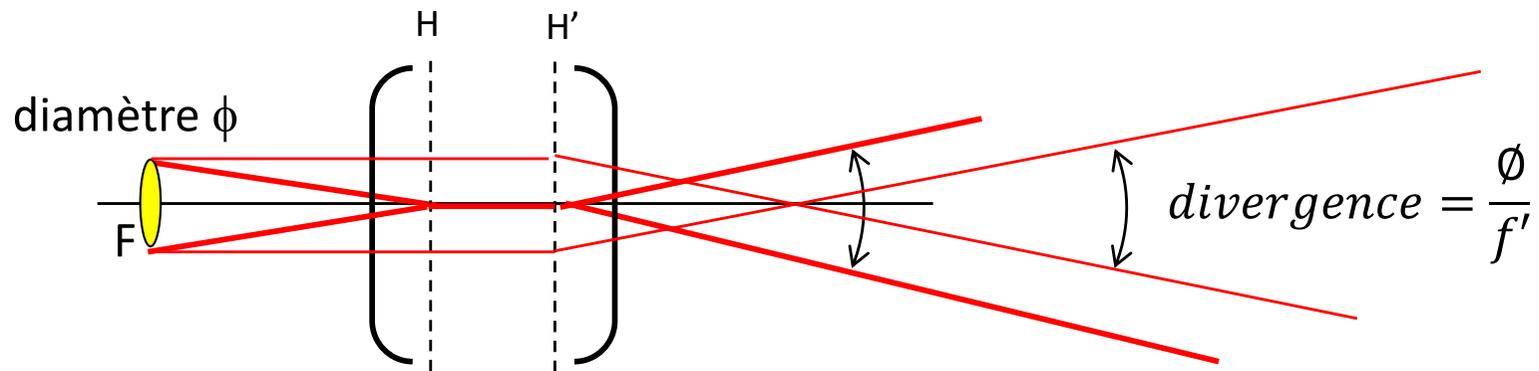
Une source non ponctuelle ne peut pas être parfaitement collimatée (faisceaux parallèles)
