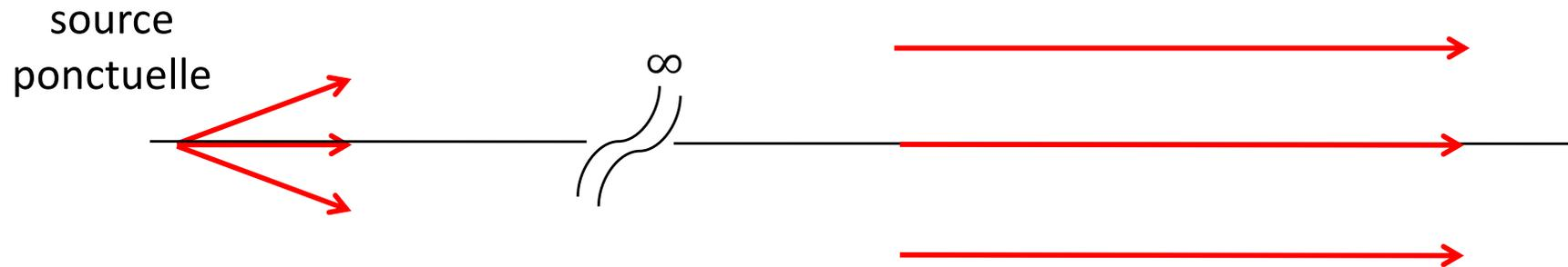
Tous rayons parallèles à l'axe proviennent réellement ou virtuellement d'un point source à l'infini sur l'axe
