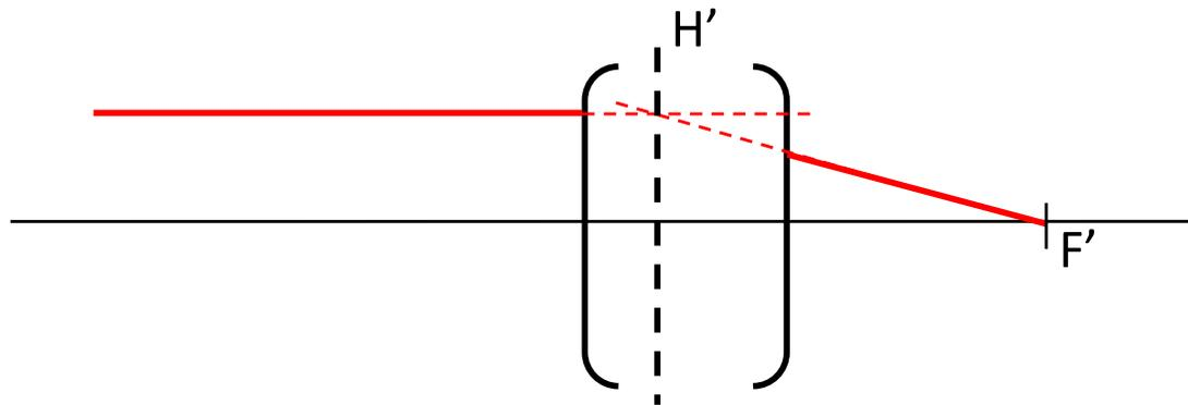
On appelle **plan principal objet  $H$** , le plan orthogonal à l'axe passant par l'intersection du rayon incident passant par  $F$  et émergent // à l'axe
