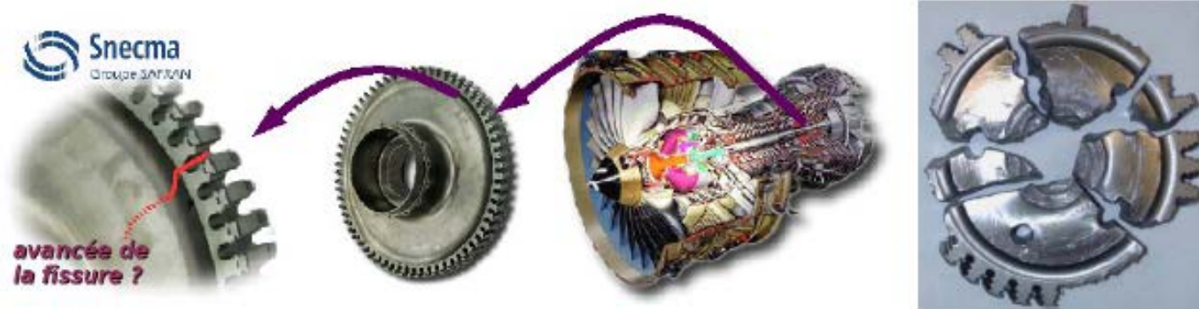
Fig. 4.23: Disques de turbine (SNECMA Moteurs); exemple de disque après éclatement.
