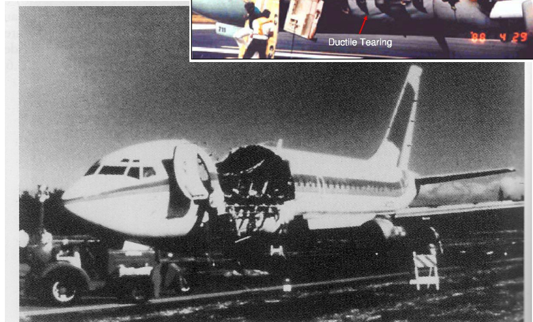
Figure IV.8.7. - Déchirure du fuselage d'un Boeing 737 le 28/04/1988 de la compagnie américaine Aloha. Cliché communiqué par R. Pelloux.
