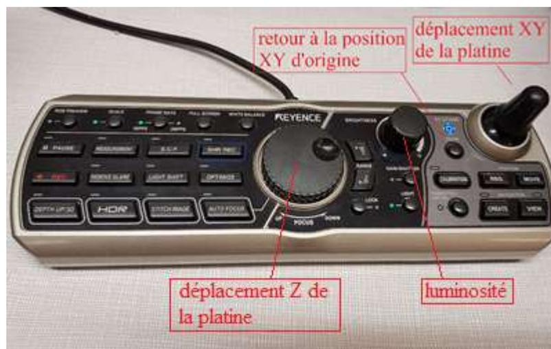
Image 7 : Déplacement de la platine porte échantillon avec la manette et retour à l'origine de la platine bouton ORIGIN, voir platine de commande
