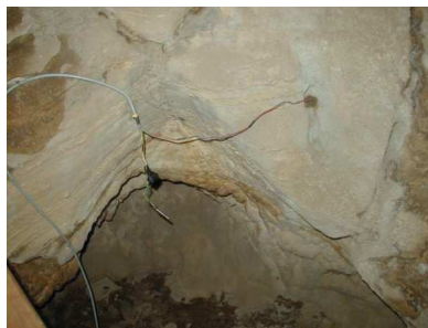
Mesure de la température de l'air et de la roche par PT100
